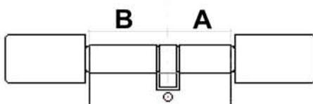
Bei Knaufzylindern oder Digitalen Zylindern (Abb.) muss zwischen Knauf und Beschlag genügend Platz sein. Wählen Sie den Zylinder nicht zu kurz um ausreichende Montage- und Bewegungsfreiheit zu gewährleisten.
