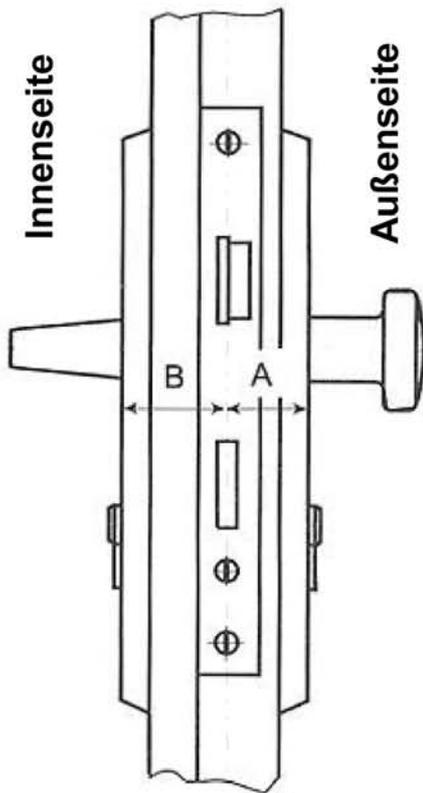
Zur Ermittlung der Zylinderlängen messen Sie von der Bohrung für die Stulpschraube bzw. Mitte des Riegels bis zur Außenkante des Türbeschlages jeweils zur Außen-(A) und zur Innenseite (B).
